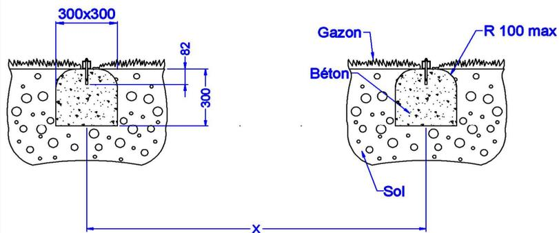
Couler les massifs béton suivant les dimensions indiquées ci-après
