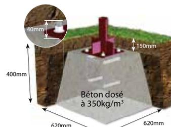
Béton dosé à 350kg/m<sup>3</sup>
