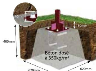
Béton dosé à 350kg/m<sup>3</sup>
