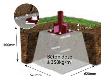
Béton dosé à 350kg/m<sup>3</sup>
