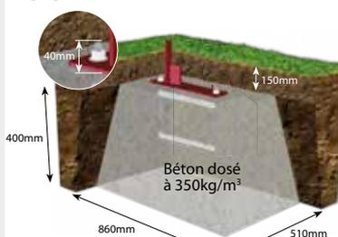
Béton dosé à 350kg/m<sup>3</sup>
