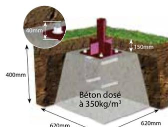
Béton dosé à 350kg/m<sup>3</sup>
