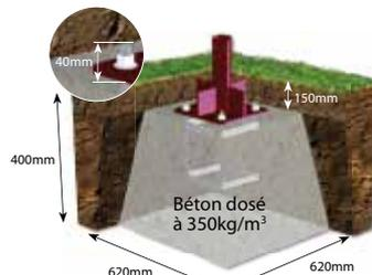
Béton dosé à 350kg/m<sup>3</sup>
