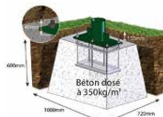
Béton dosé à 350kg/m<sup>3</sup>
