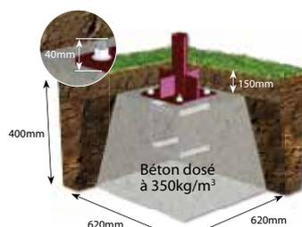
Béton dosé à 350kg/m<sup>3</sup>
