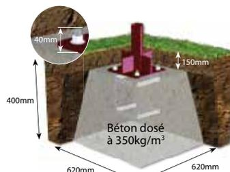
Béton dosé à 350kg/m<sup>3</sup>
