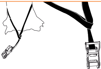
MISE EN PLACE CLIQUET ET LONGE/ RATCHET AND SLING SET UP/ EINRICHTUNG DER SCHLINGE UND DER RATSCHÉ
