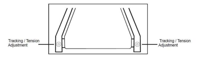
Note : les ajustements se font par des petits trous à travers les bouchons.
